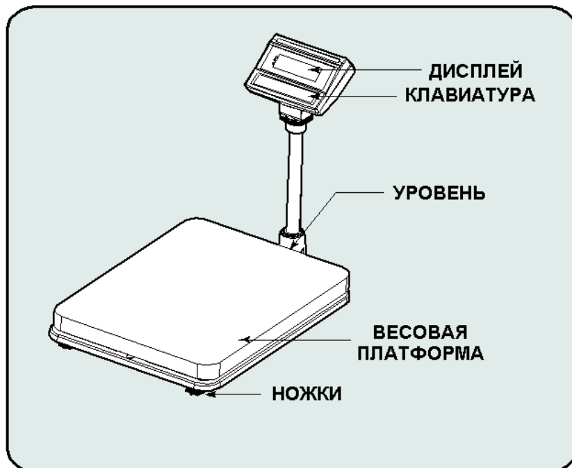
Рис. 5.1 - Внешний вид и основные элементы весов HD
